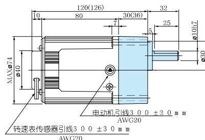
※ ( )内尺寸表示的是M X 7 G □B (M) (减速比1 / 30 以上) 的尺寸。
