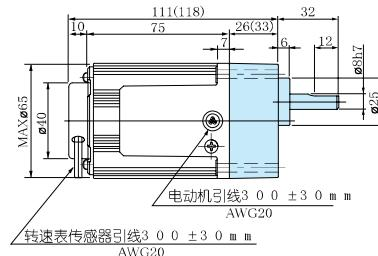
※ ( )内尺寸表示的是M X 6 G □B (M) (减速比1 / 30 以上) 的尺寸。
