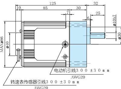
※ 电动机的型号末尾为A的产品，表示电容罩不作为产品附件提供。
